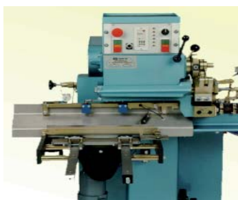
进料斗和螺旋式收料斗最多可以容纳 700 根锯条。
