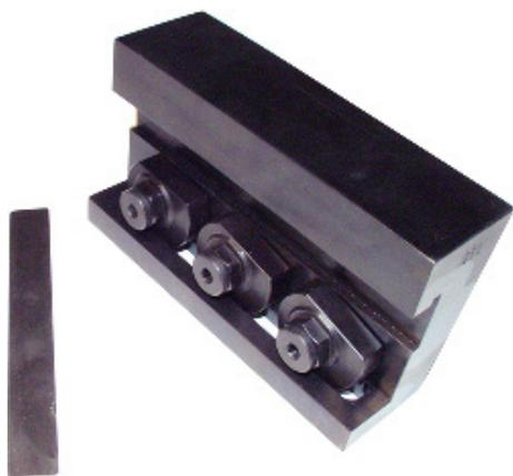
该研磨夹具适用于型号为606及607的分齿模，更短的分齿模同样可以通过该夹具研磨。
