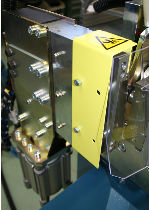
该新型改进的切割剪组件应用于自动裁断机上
