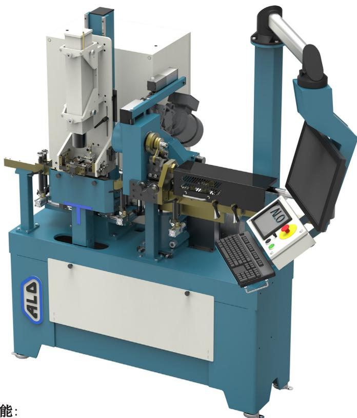
带有SGS摄像系统的ALO新一代分齿机将帮助您监控及全面控制分齿的过程及质量。
