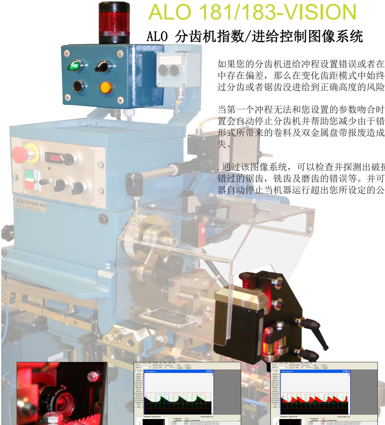
该图像系统固定在带锯条进给位置的侧面
