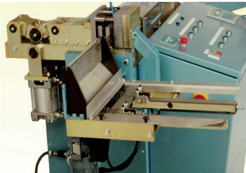
*Imagen que muestra la junta basculante compacta y el depósito de recogida.*
