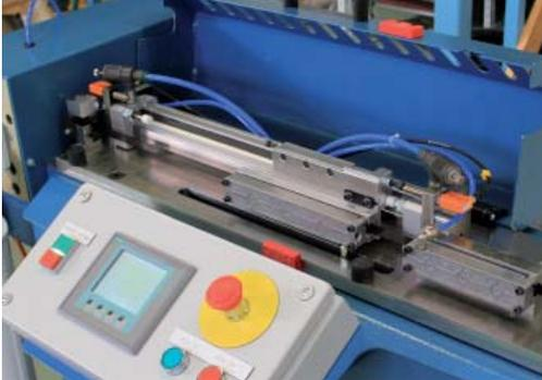
*El sistema de alimentación con mandíbulas de sujeción en cada lado.*
