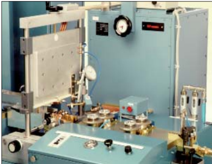
Generador de endurecimiento de dientes
