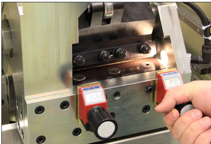
改进的钳口及数显千分尺，使得钳夹调节更加方便。
