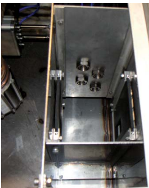
Cámara de pulverización de inhibidor de óxido
